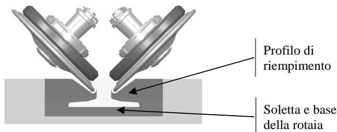
Il profilo di riempimento deve imperativamente rispettare i profili indicati sullo schema F00326953; non rispettare questo profilo rischia di compromettere la sagoma dinamica dei rulli, poiché il contatto ruotino/materiale di fissaggio può creare un'usura precoce e una sollecitazione verticale sulla coppia di rulli.
