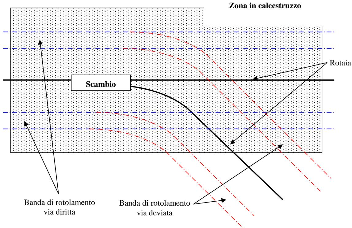
Le velocità con cui vengono superati gli scambi in via deviata sono dell'ordine dei 10-15 km/h. La loro costruzione (raggio costante dell'ago in deviata) fa sì che lo strappo (jerk) sia ben percepibile. In linea diritta, la velocità di passaggio sopra uno scambio può raggiungere la velocità massima del veicolo, ovvero 70 km/h.
