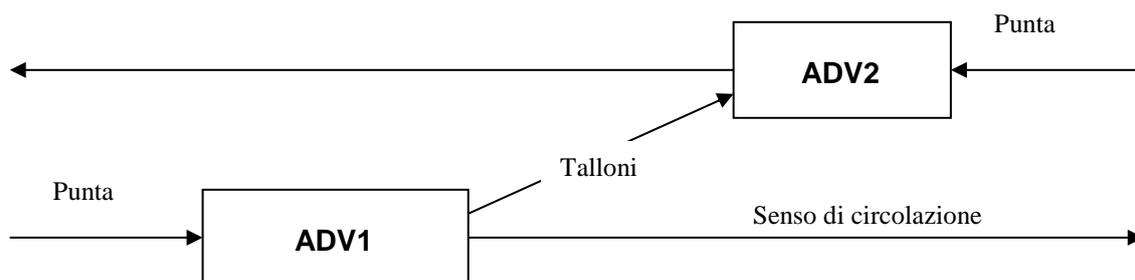
Gli scambi rispetteranno le stesse regole della via corrente. Le rotaie fisse e mobili, che assicurano la funzione di guida sugli scambi, saranno quindi fornite di un cordone di saldatura inox, conformemente al paragrafo 6.4. Allo stesso modo, gli scambi rispetteranno le condizioni descritte nel paragrafo 6.
