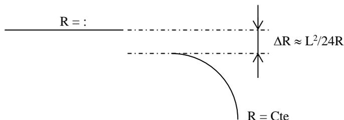
L'inserimento delle clotoidi è di prima importanza poiché le discontinuità di curva possono generare urti e picchi di accelerazione trasversale che degradano il comfort, e che possono mettere in causa i livelli di dimensionamento in fatica delle strutture.
