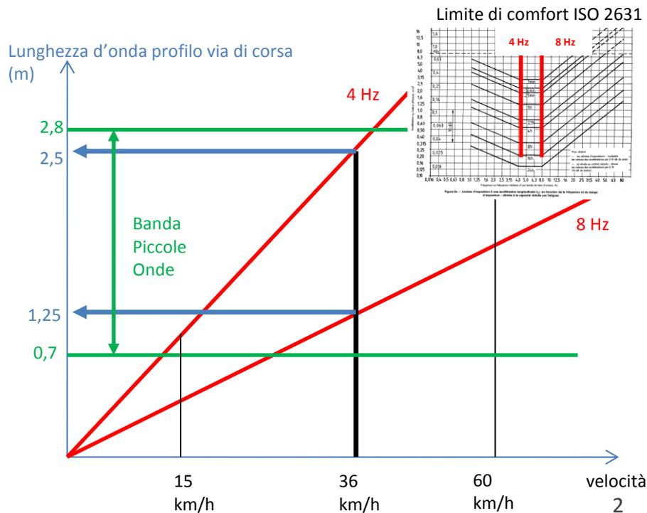
Inoltre il filtraggio nell'ambito delle onde piccole permette di svincolarsi dalle irregolarità locali della via di corsa (sassi, piccoli difetti, forte granulometria), che sono naturalmente filtrate dagli pneumatici e non rientrano nell'ambito del comfort vibratorio. Tali elementi saranno importanti per la comparsa del rumore di rotolamento, ma a velocità superiori a 90 km/h, il che si trova oltre il campo di applicazione del Translohr.
